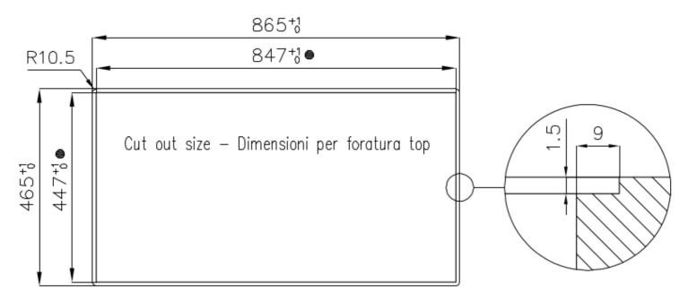
• Built-in cut out for FTS - Foratura per installazione FTS
